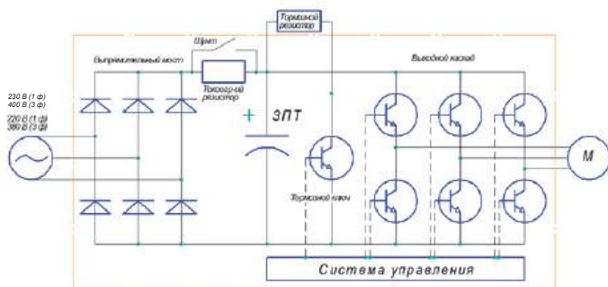
Рис.2.1.Принципиальная электрическая схема ПЧ
